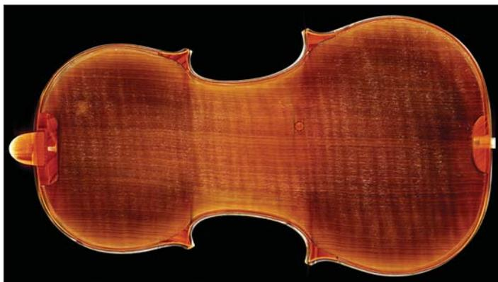
*L'immagine micro-tomografica del Kreisler mostra il perfetto stato conservativo del fondo dello strumento; la parte interna dello zocchetto del manico, che copre un'aggiunta posteriore, è stata altresì preservata assieme al manico stesso ed è riconoscibile per il foro che accoglieva uno dei chiodi di fissaggio.*
